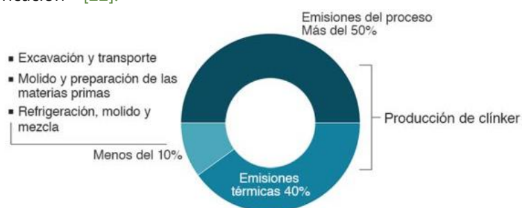
Fig.22. Gráfico sobre la proporción contaminante de Clinker en el proceso total de producción del cemento. Fuente: BBC.
