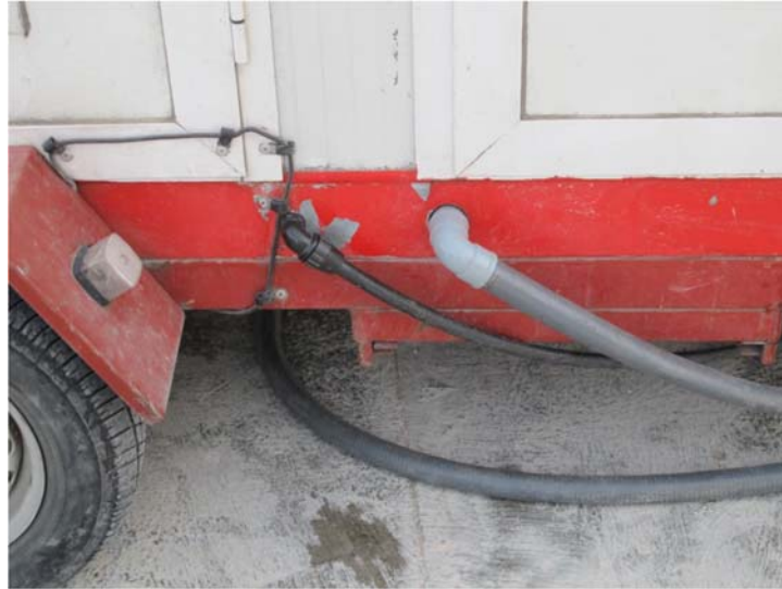
Ilustración 2 conexión de abastecimiento y desagüe
