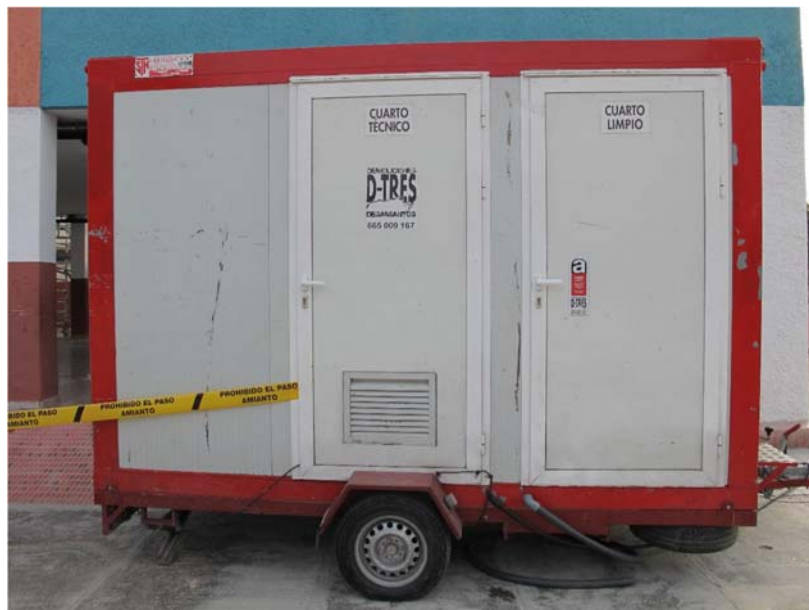
Ilustración 1 unidad de descontaminación
