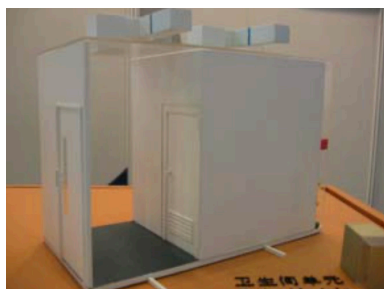
Figura 23: Maqueta de un módulo tipo para los aseos del hospital Xiaotangshan
