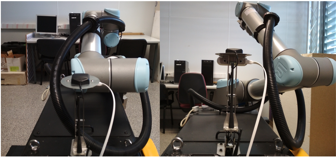
Figura 6.6: Izquierda: Brazo recogido. Derecha: Posición del brazo para el uso de la cámara
