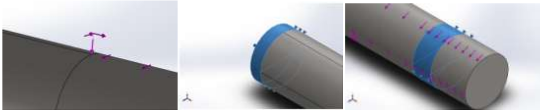
Figura 1. Fuerzas, apoyos en el eje del tornillo y momento torsor (SolidWorks Corp, 2020)
