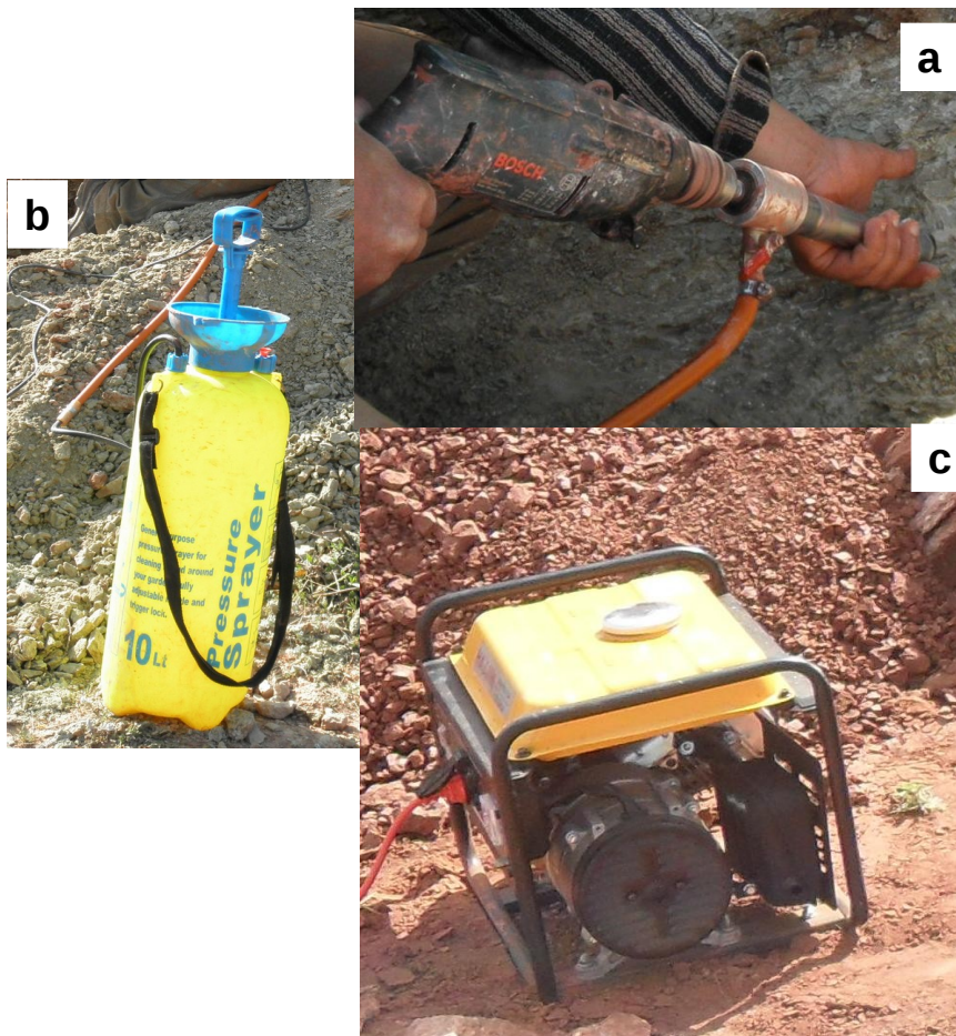
Figure.III.1. Appareillage utilisé lors de la perforation des couches rouges. a) foreuse électrique b) bidon à injection d'eau sous pression c) groupe électrogène à essence.
