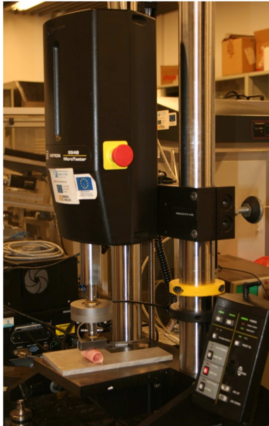
Imagen 10: Máquina Instron 5548 MicroTester utilizada para el estudio de compresiones.
