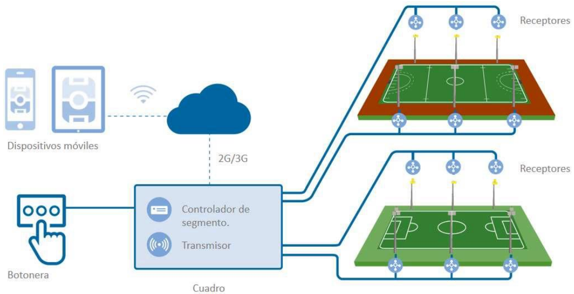
Figura 7. Disposición esquemática del sistema PerfectPlay. Fuente: Phillips
