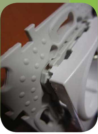
Anclaje de la base enchufe entre el marco de plástico
