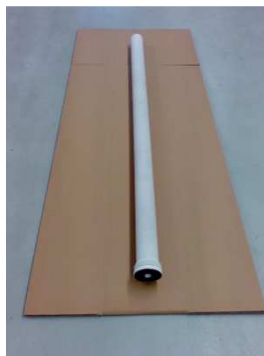
Figura 14. Prototipo de filtro catalítico de 1534 mm de longitud.
