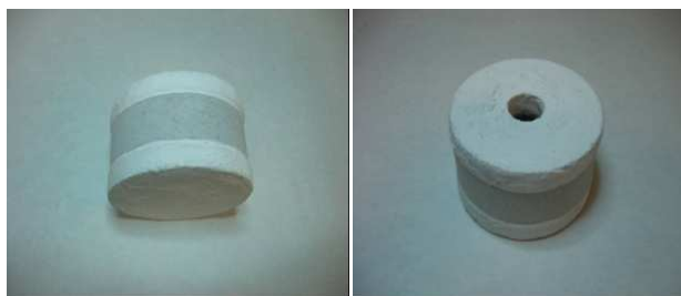
Figura 15. Filtro catalítico de dimensiones (70/50/30/16)x21mm.
