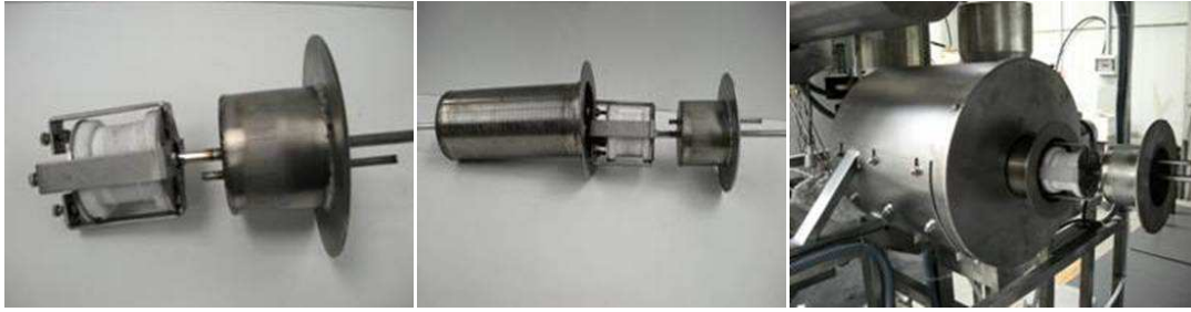
Figura 13. Imágenes del filtro catalítico y del horno.
