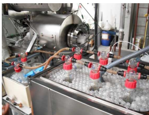
Figura 18. Imagen del sistema de recogida de alquitranes.
