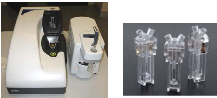
Figura 22: Equipo Zetasizer Nano y recipientes.
