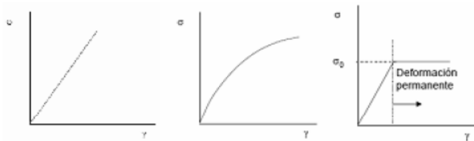
Figura 6: Curvas de esfuerzo deformación de materiales elástico lineal (a), elástico no lineal (b) y elastoplástico (c).
