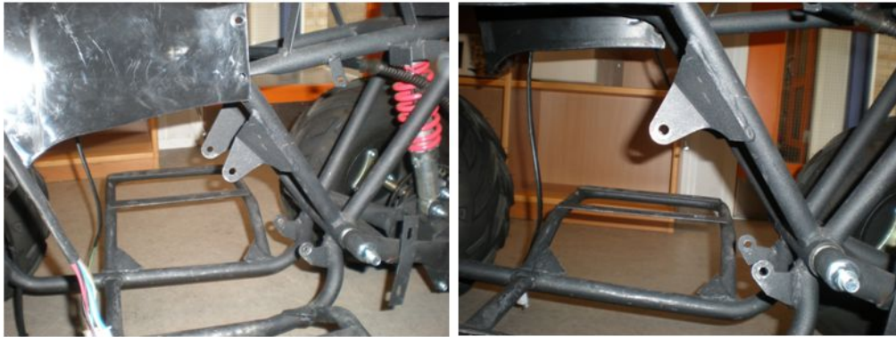
Figura: espacio elegido para alojar y fijar el motor
