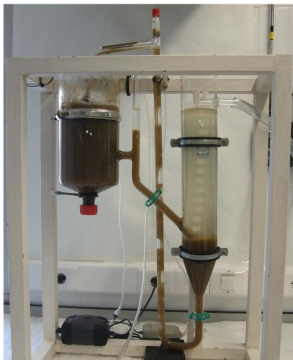
Figura 3. Planta piloto de lodos activos
