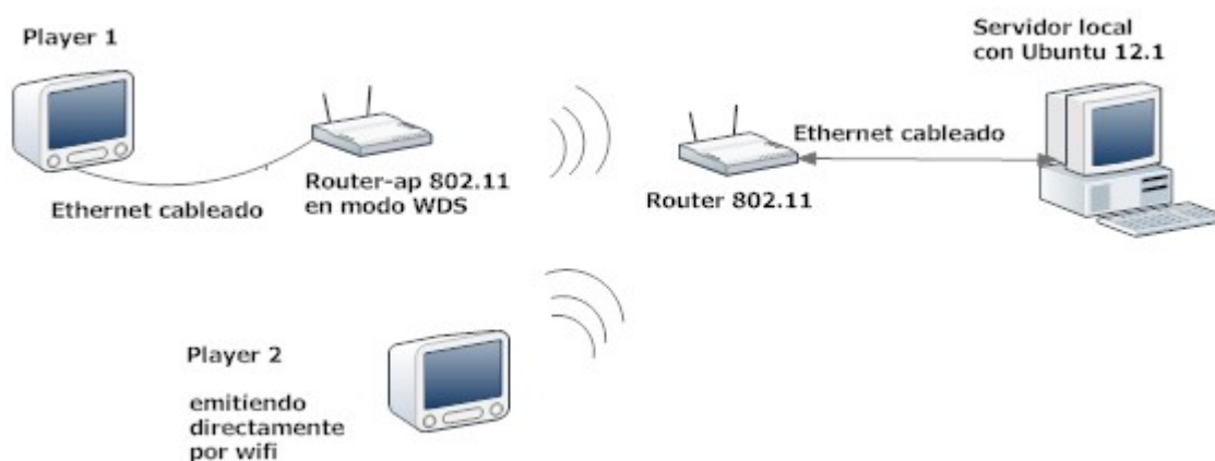
Figura 4-11: Alternativa al uso de hardware USB 802.11: Cliente Wi-Fi.
