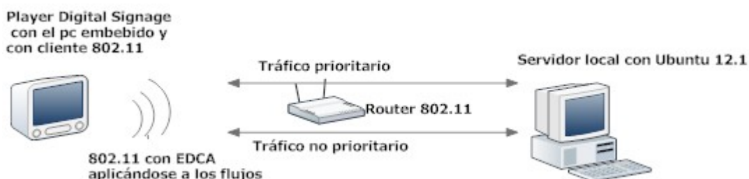
Figura 4-7: Escenario de pruebas para comprobar el funcionamiento de EDCA en caso de flujos de tráfico múltiples en el propio dispositivo
