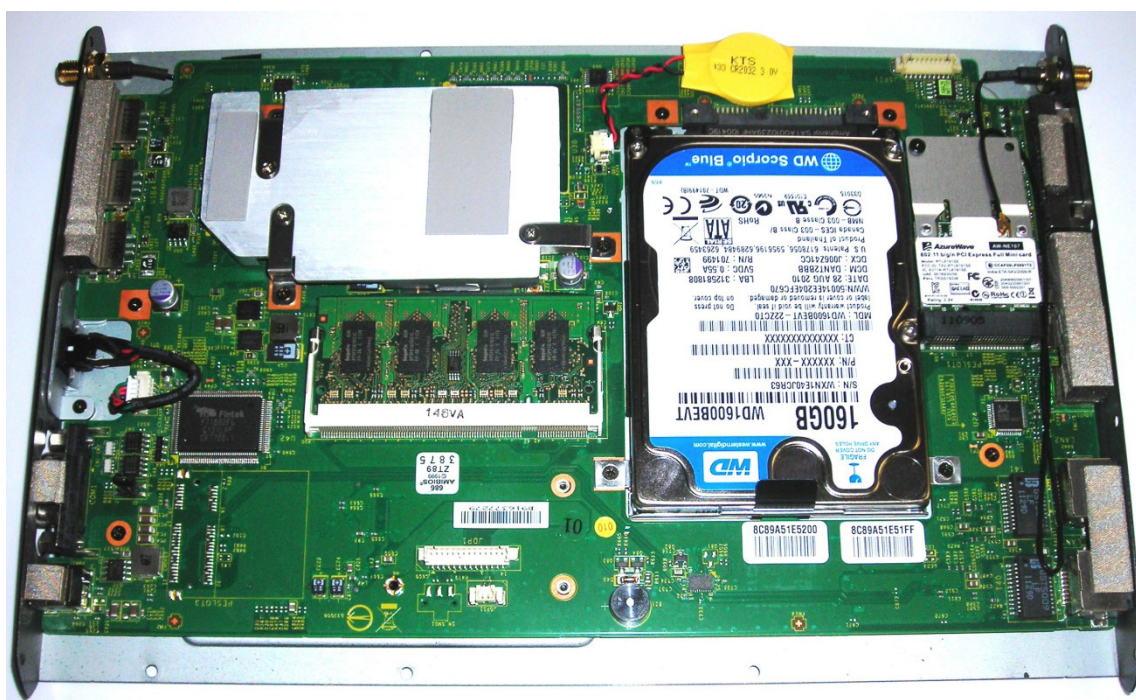
Figura 6-4: Esd2: Interior del dispositivo
