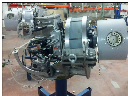
Ilustración 14 Aerogenerador Eole-System: presentación del aerogenerador en un salón y diseño del mecanismo en taller (Eole-System, 2012)
