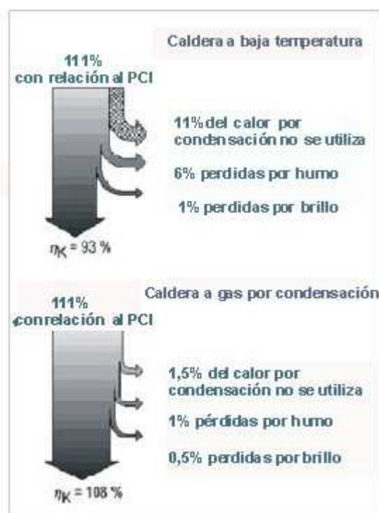
Figura 8.4. Comparación \eta caldera baja temperatura vs caldera condensación [ www.caloryfrío.com ]
