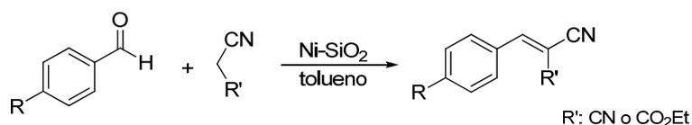
**Esquema 2.60.** Condensación de Knoevenagel catalizada por Ni-SiO<sub>2</sub>.
