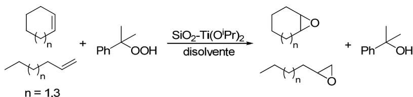
**Esquema 1.21.** Epoxidación de alquenos con CHP y  $\text{SiO}_2\text{-Ti}(\text{O}^i\text{Pr})_2$  como catalizador.
