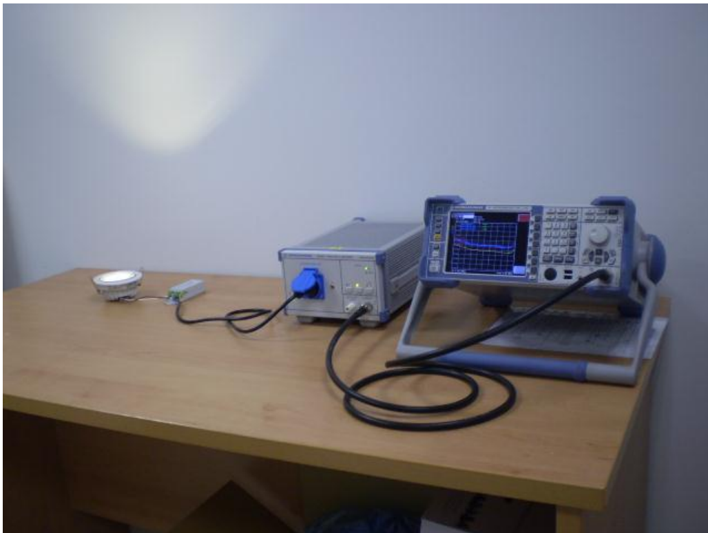
Figura 24. Ensayo EMC. LISN y analizador de espectros
