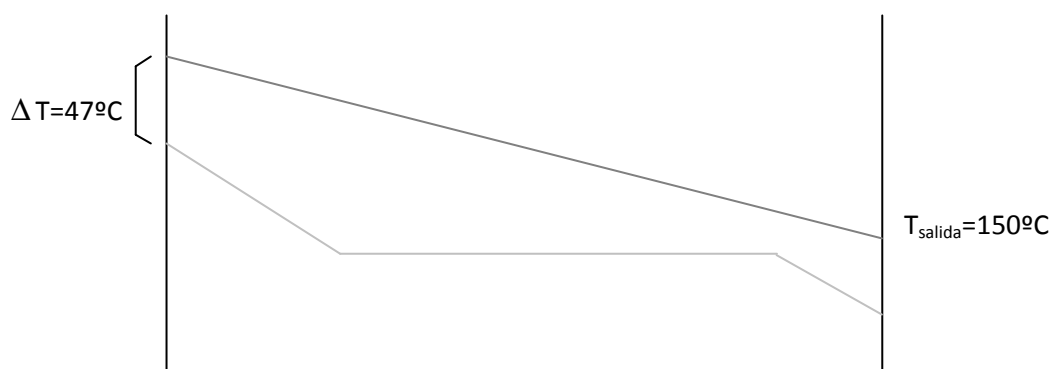
Fig. 2 Esquema de funcionamiento del HRSG [Fuente propia]
