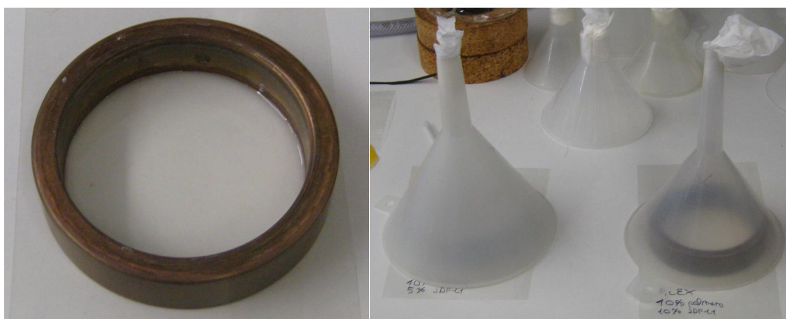
Figura 2.4: Preparación de una membrana en anillo de metal sobre una lámina de PET. Izquierda, disolución en el anillo antes de ser tapada; derecha, membranas cubiertas con embudos.
