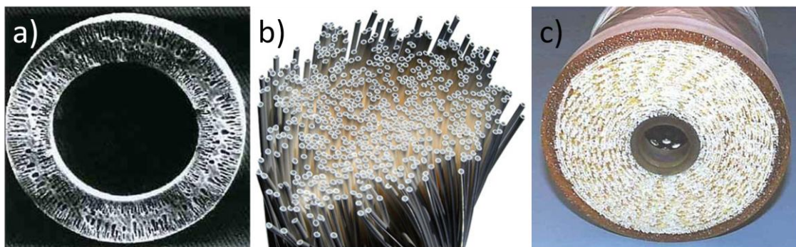
Figura 1.12: a) Sección transversal de una fibra hueca. b) haz de fibras huecas. c) módulo con las fibras huecas empaquetadas.
