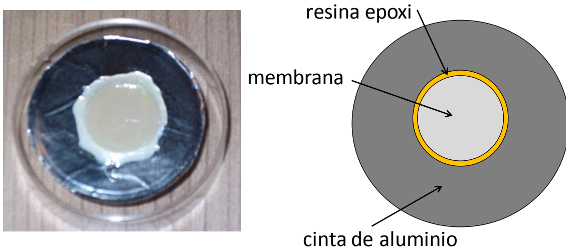
Figura 2.5: Izquierda, fotografía de una membrana (M9 de la tabla 2.4) preparada con aluminio y resina. Derecha, esquema de una membrana preparada con este método.
