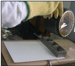
Figura 1.4: Aplicación del adhesivo fundido
