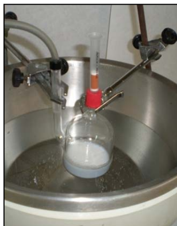
Figura 4.4: Montaje para la extracción HS-SPE
