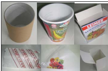
Figura 2.2: Envases de mercado analizados, con estructura de laminado formados por distintos adhesivos
