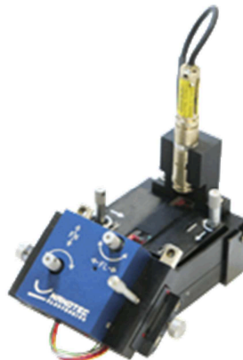
Figura I 1 Cabezal AFM de la empresa española Nanotec a integrar en el sistema de posicionamiento (8)
