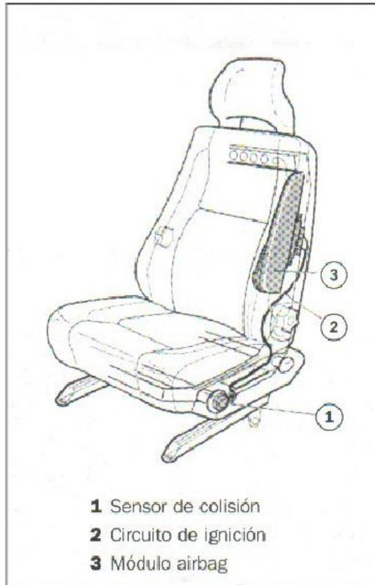
Figura 17. Constitución del airbag lateral
