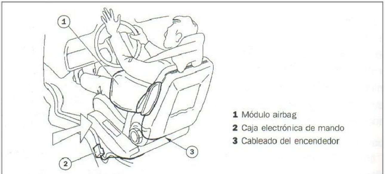
Figura 18. Colocación del sistema del airbag lateral
