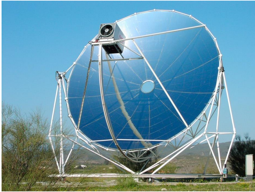
Figura 11 Disco solar parabólico/motor Stirling [16].
