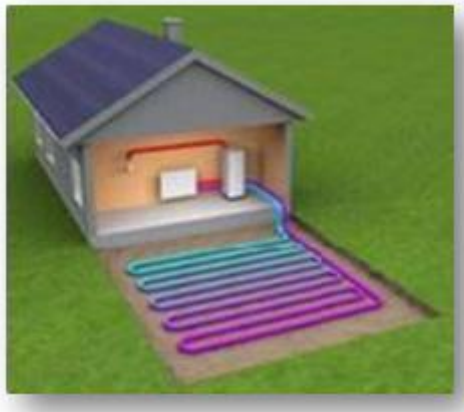
Figura 7.6: Disposición de colectores horizontales enterrados
