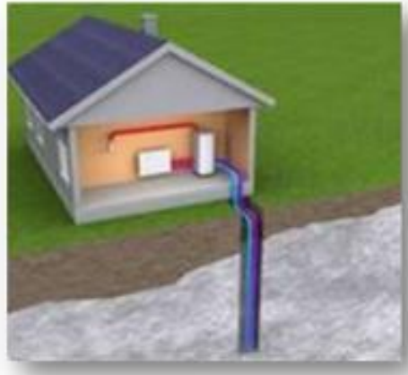
Figura 7.7: Disposición de sonda geotérmica vertical
