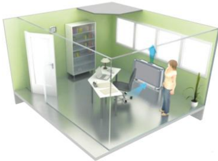
Figura 10.2: Situación de una estancia climatizada mediante Fancoil
