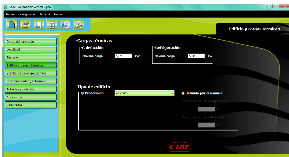
Figura A.2.3: Menú “Edificio y cargas térmicas” en el programa Geo2 1.0 v de la empresa CIAT
