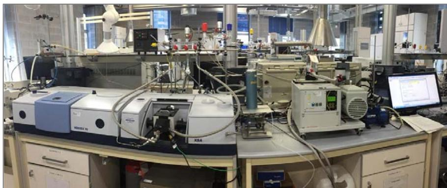
**Figura 3.10. Espectrómetro DRIFT de Bruker compuesto por dos módulos: Vertex 70 con detector DTGS y XSA con detector MCT. Perteneciente al grupo de investigación SUPREN, Universidad del País Vasco (UPV/EHU)**
