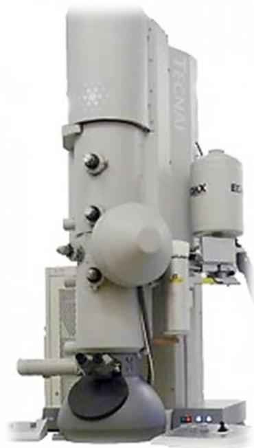
*Figura 3.13. Microscopio electrónico de transmisión TEM Tecnai F30, FEI Company. Perteneciente al Laboratorio de Microscopías Avanzadas del Instituto de Nanociencia de Aragón de la Universidad de Zaragoza*
