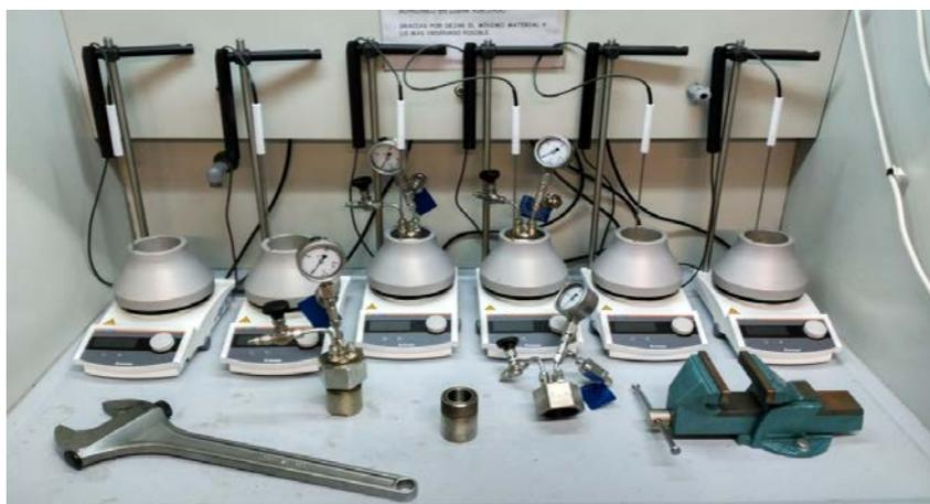
**Figura 3.16.** Instalación experimental de seis reactores tipo *batch* de la Universidad del País Vasco
