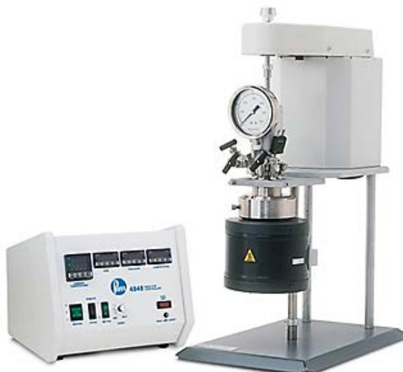
Figura 3.17. Reactor tipo batch de Technische Universität München
