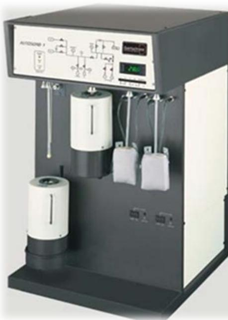
**Figura 3.6. Autosorb®-1-C/TCD (Quantachrome Instruments) para fisisorción de  $N_2$**
