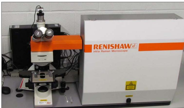
**Figura 3.4. Microscopio confocal Raman. Perteneciente a los Servicios Generales de Investigación de la Universidad del País Vasco (UPV/EHU)**
