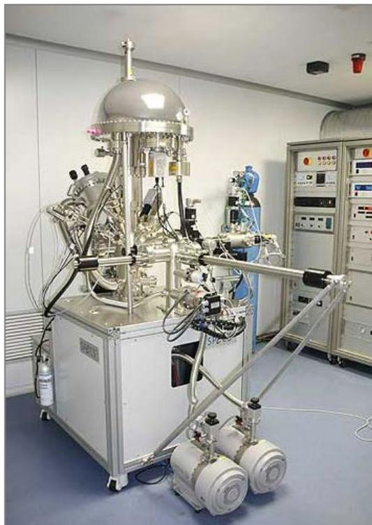
*Figura 3.5. Sistema de Espectroscopía Fotoelectrónica de Rayos X (XPS) SPECS. Perteneciente a los Servicios Generales de Investigación de la Universidad del País Vasco (UPV/EHU)*
