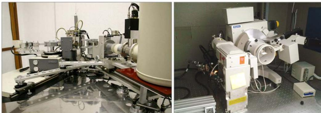
*Figura 3.2. Generador de Rayos X ROTAFLEX Ru-300 18 kW (izquierda) y difractómetro de Rayos X de polvo de ánodo rotatorio RIGAKU D/max 2500 (derecha). Perteneciente al Servicio General de Apoyo a la Investigación de la Universidad de Zaragoza*
