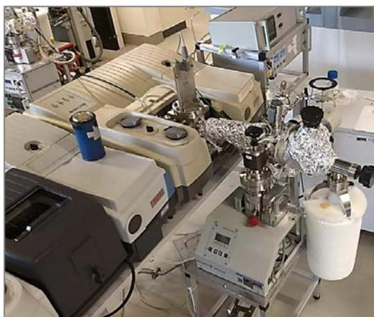
**Figura 3.11. Instalación de FTIR con sistema de vacío de Thermo Scientific FTIR Nicolet y detector MCT. Perteneciente al grupo de investigación Lehrstuhl für Technische Chemie II, Technische Universität München (TUM)**
