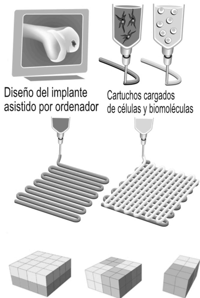
**Imagen 15:** esquema de la impresión de tejidos, previo diseño asistido por ordenador utilizando cartuchos cargados de células y biomoléculas (295).
