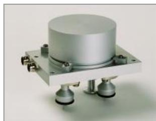
**Figura II-3: Cabeza de la balanza.**
