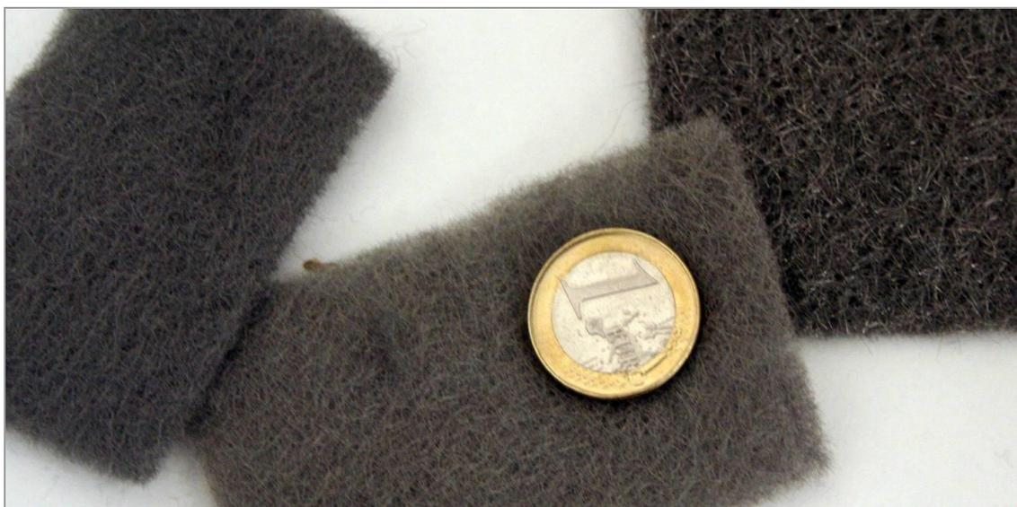
**Figura V-90: Aspecto macroscópico de mallas de filtración sin sinterizar. De izquierda a derecha: wb Fecralloy 22/350 g, wb 22/300 g, wb NIT. +500 g.**
