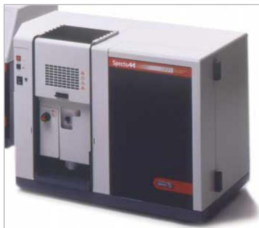
**Figura II-14: Espectrofotómetro de absorción atómica VARIAN.**
