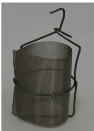
Figura IV-21: Monolito de 1 vuelta de malla.
