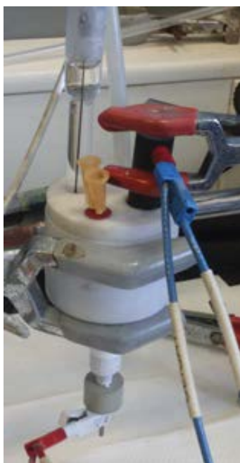
Figura A2A.24. Celda de tres electrodos utilizada en los experimentos electrocatalítico.
