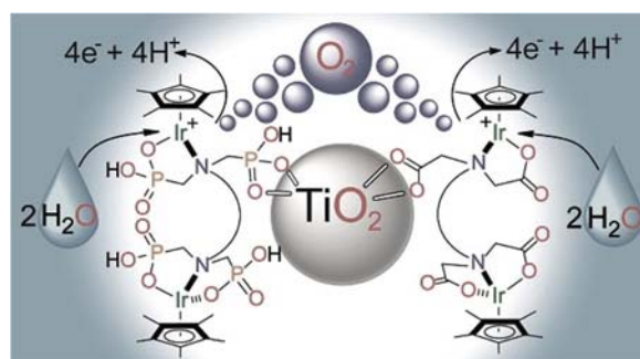
Figura 2.16. Catalizadores dinucleares Ir-Cp* heterogeneizados sobre \text{TiO}_2 con actividad en oxidación de agua.
