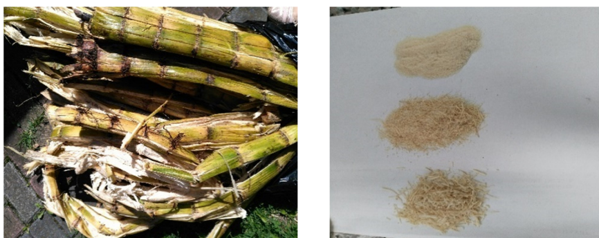
Figura 3.3 Bagazo de caña de azúcar antes y después del proceso de preparación
