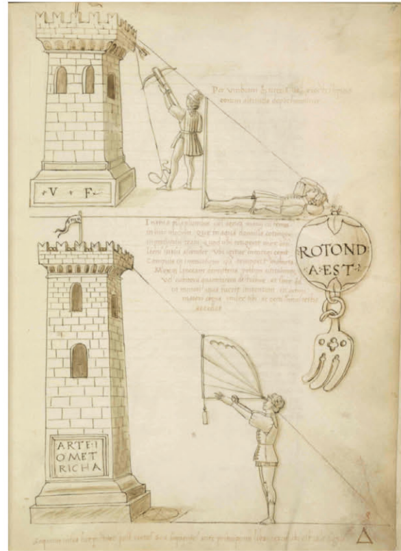
Fig. II16. Mediciones de altura de murallas y torres. Robertus Valturius. De re Militari.
