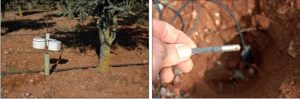
**Figura 4.12.-** Sondas de temperatura y humedad empleadas para la captura de datos ambientales.
