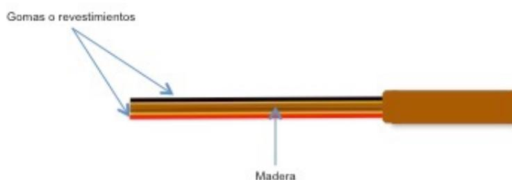
FIGURA 8. Partes de una pala (Pradas, Herrero, y Plà, 2015)
