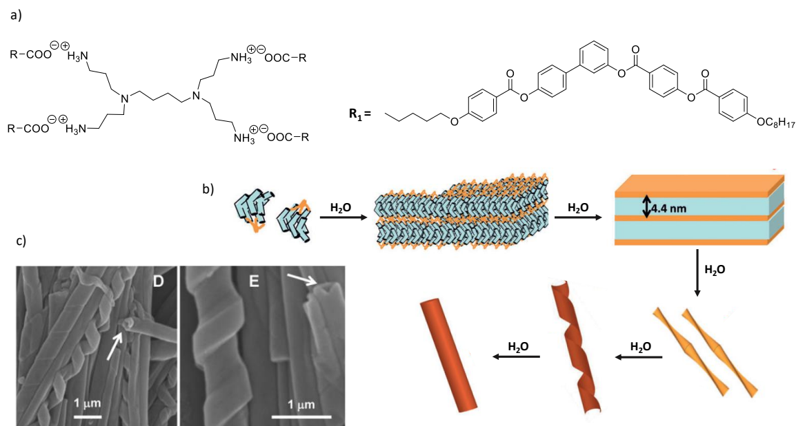
Figura 14. a) Ejemplo de estructura química de los dendrímeros iónicos basados en estructuras bent-core . b) Modelo de empaquetamiento de los dendrímeros en presencia de agua. c) Imágenes de SEM de las cintas helicoidales y nanotubos formados por un dendrímero iónico en suspensión acuosa. Adaptado de Angew. Chem. Int. Ed. 2014 , 53, 13449–13453.
