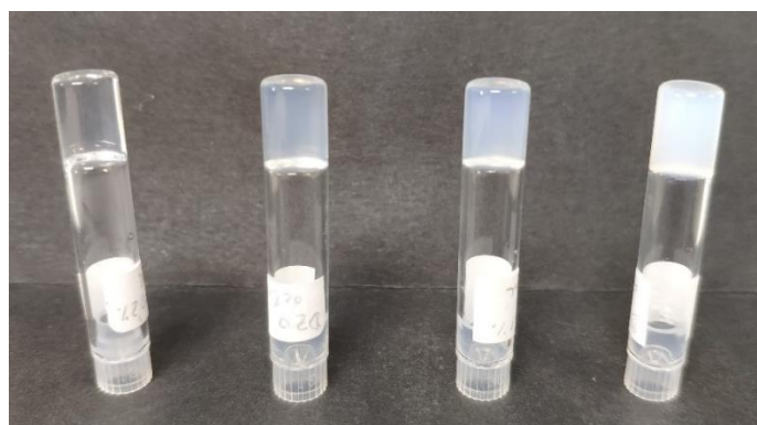
Figura 17. Fotografía de los geles de TEG-B1-0-14 en 1-octanol al 0.2 wt%, 0.5 wt%, 1 wt% y 2 wt% (de izquierda a derecha). La capacidad gelificante se comprobó mediante el test de inversión del vial .
