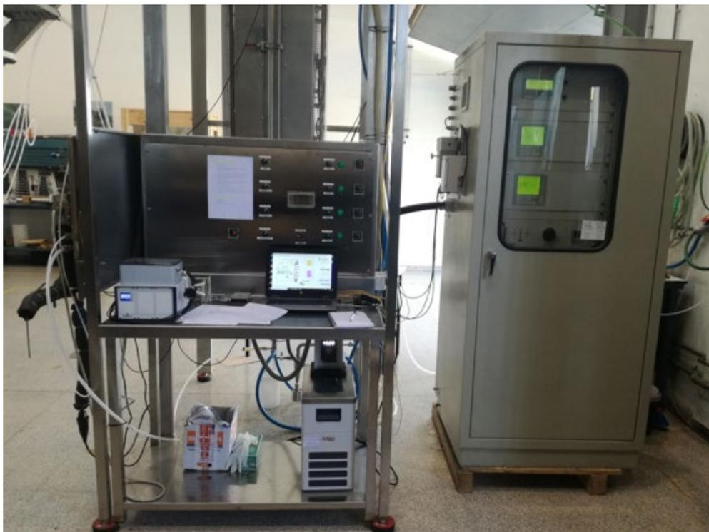
Figura 67. Panel de mandos de la planta, enfriador (abajo) y analizador de gases (derecha).
