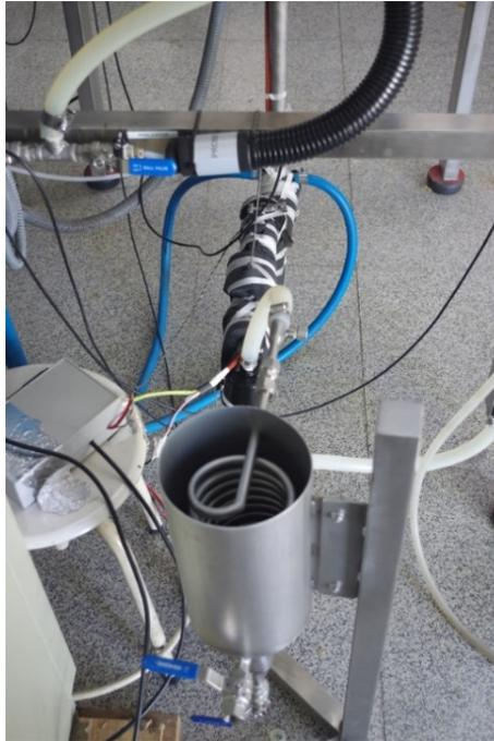
Figura 65. Condensador.
