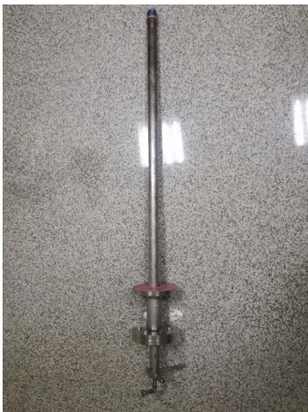
*Figura 57. Sonda de gases.*
