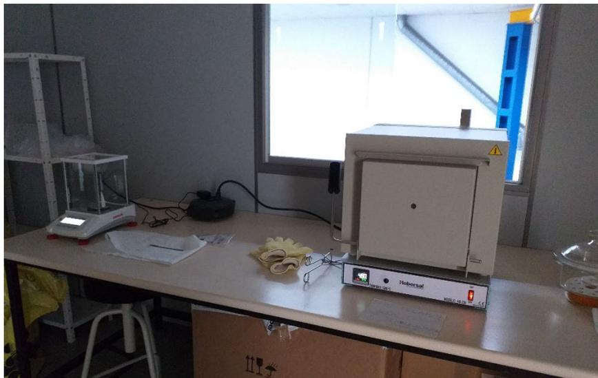
*Figura 80. Mufla (centro), balanza (izda.) y desecador (dcha.).*
