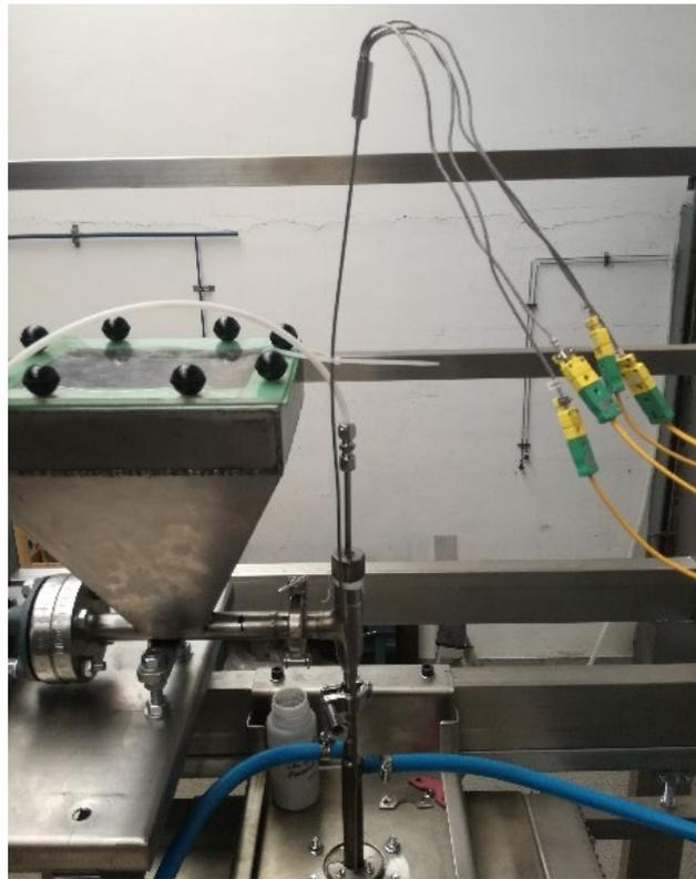
*Figura 69. Posición de termopar multipunto para realización de perfil de temperatura.*
