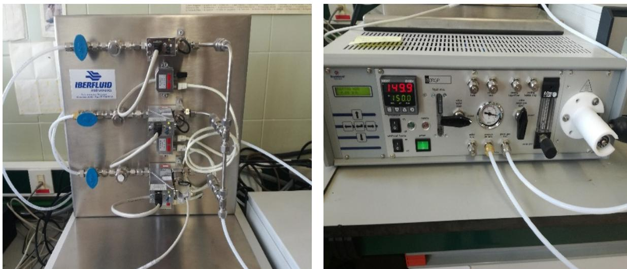
Figura 24. Izda.: panel de controladores másicos; dcha.: generador de vapor.
