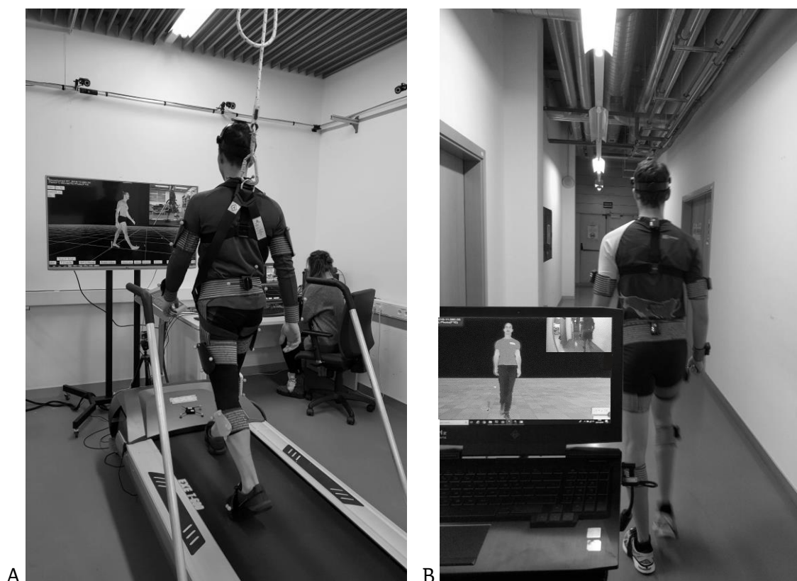
Fig 2. Tecnologías de captura de movimiento. A: basada en marcadores reflectantes. B: basada en sensores inerciales.
