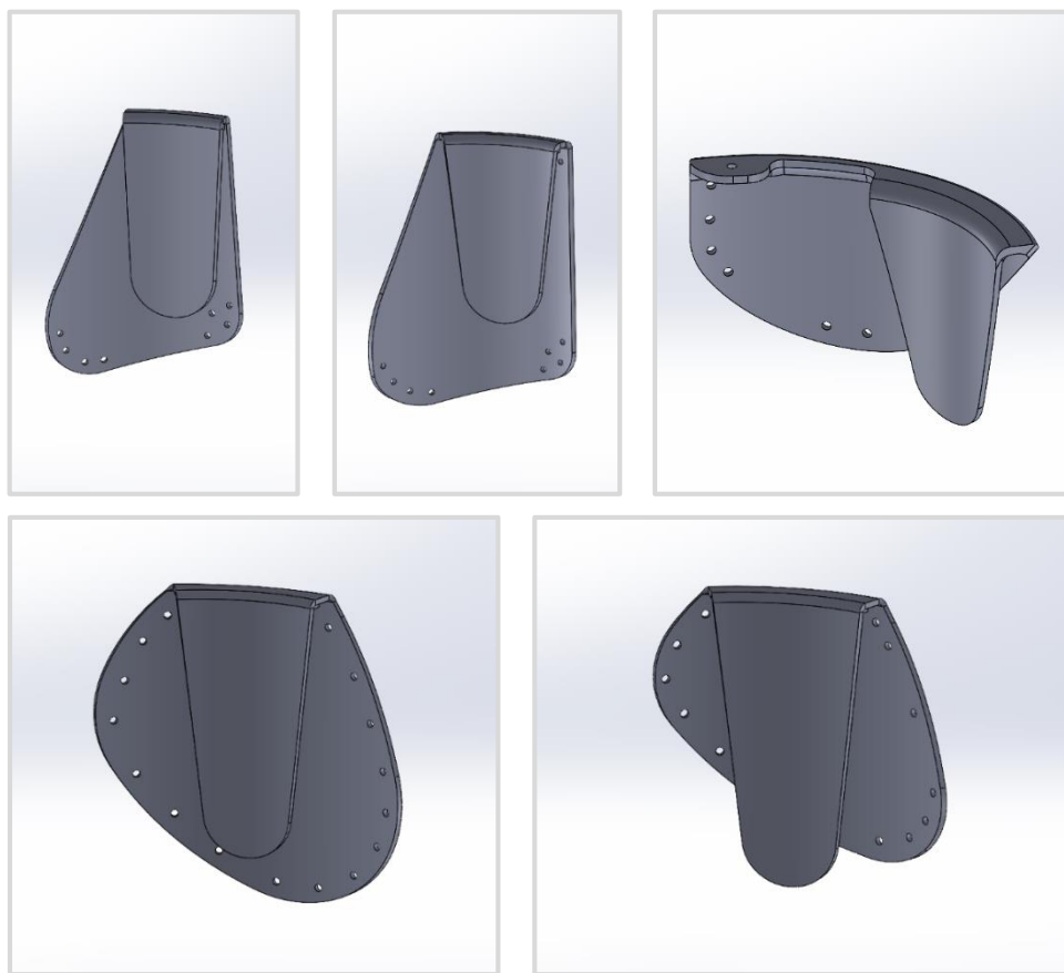
Fig 9. Sólidos rígidos a colocar en muñeca, brazo, pie, muslo y pantorrilla (orden de lectura). No incluyen esferas. Ver impresión 3D en figura 1 de estudio 4.
