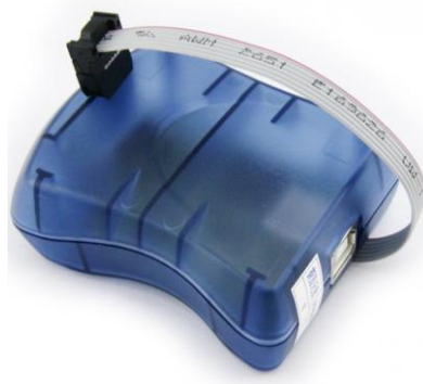
Ilustración 181 Programador AVRISP MKII de la compañía Waveshare [103]
