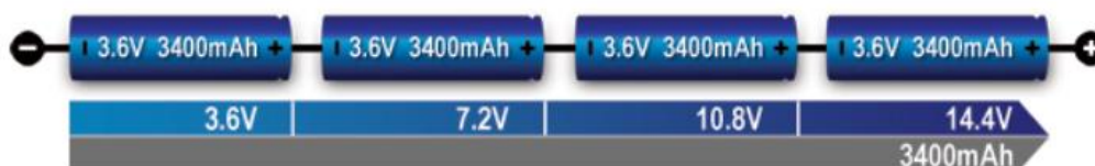
Ilustración 68 Conexión de celdas en serie [22]
