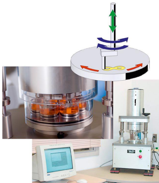
Figura 9. Equipo de seis estaciones controlado por "Pin-On-Disk"
