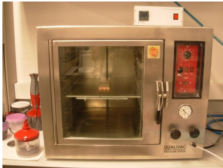
Figura 40. Horno de vacío LTE Scientific Qualivac 63
