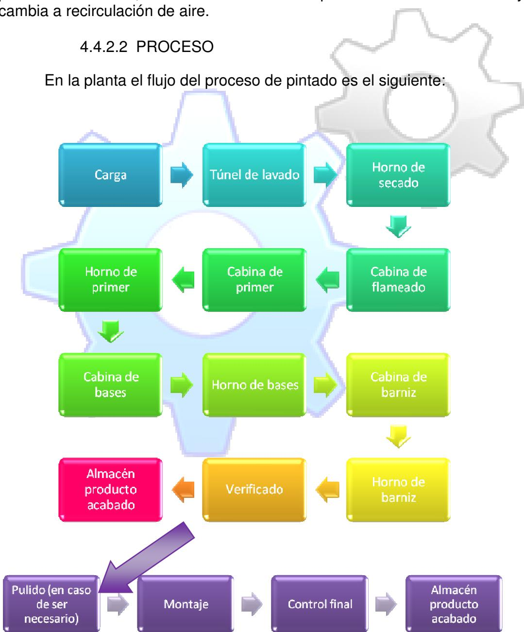
Un dato importante es que la línea posee 192 carros. En cada carro pueden ser colocadas varias piezas, dependiendo de la percha utilizada para cada modelo. Existen unos bastidores en los cuales se encajan las perchas necesarias en cada momento.
