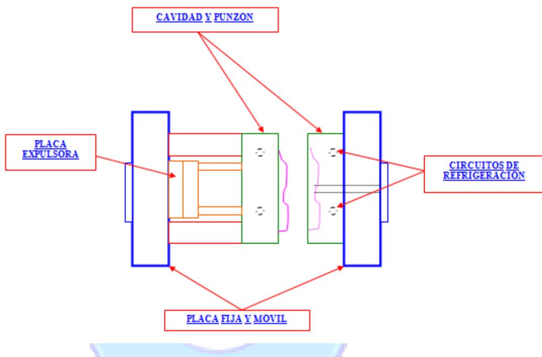
En la etapa de inyección se producen dos fases: la fase de llenado y la fase de mantenimiento:
