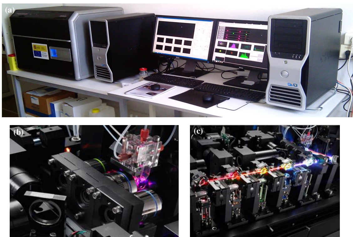
Figura 30. Citómetro de imagen, AMNIS ® , SAI Citómica, Universidad de Zaragoza. (a) Fotografía del aparato. (b) Cámara de flujo con los tres objetivos del microscopio confocal (20, 40 y 60 aumentos). (c) Láseres de 785, 658, 488 y 375 nm.
