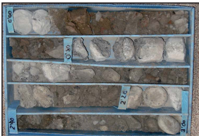
Caja nº 1 Profundidad: 0.00-3.00 m
