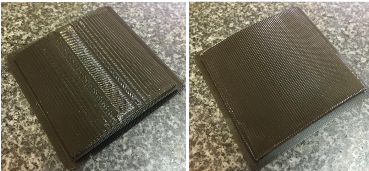
Fig. A.II-5. (Izquierda) Pieza impresa por el método FDM tradicional. (Derecha) La misma pieza impresa por un método FDM no-plano en sus últimas capas.
