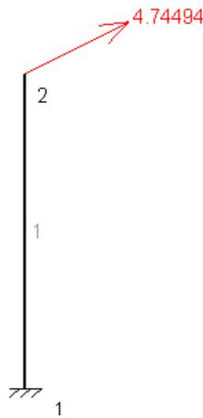
Figura 9: Poste sometido a la resultante de las fuerzas X e Y (Tracc.).
