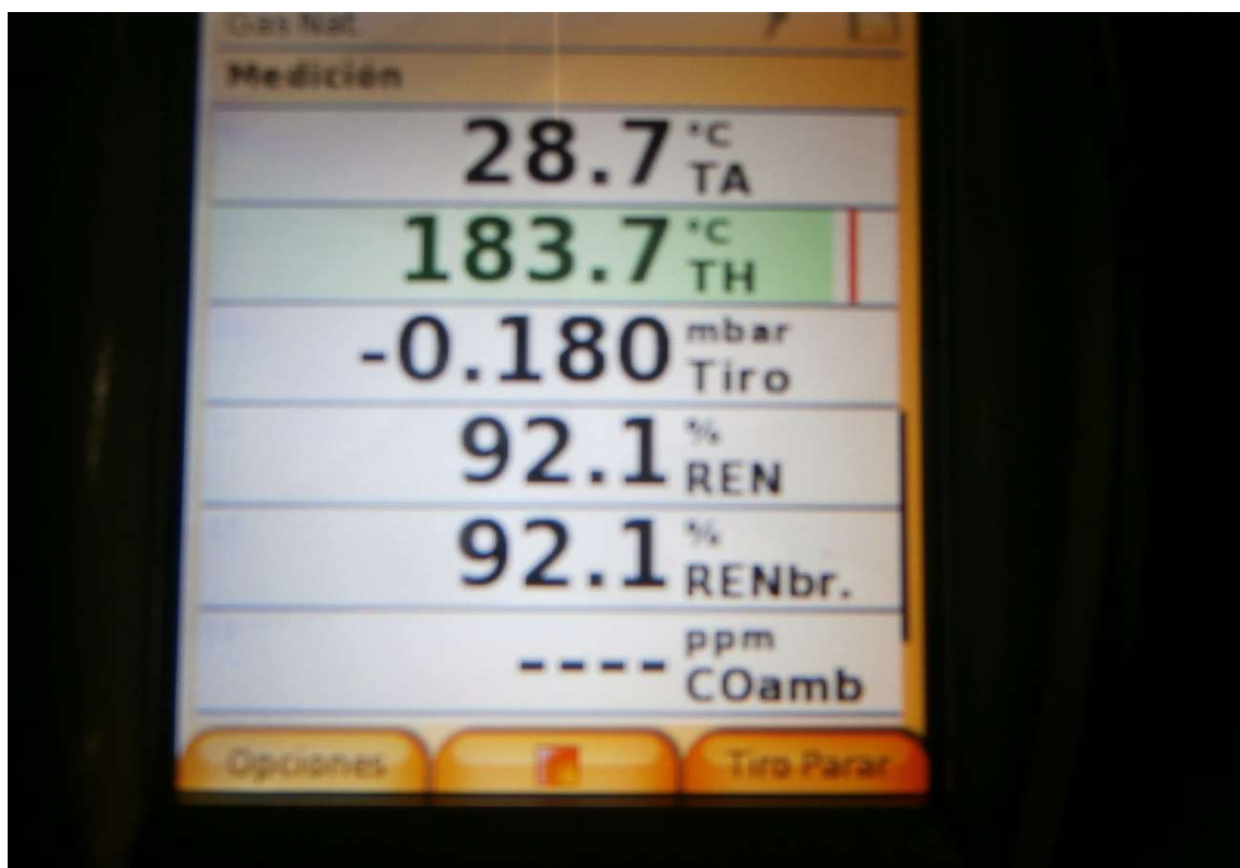
Ilustración 6 Caldera 2 Rendimiento combustión a modulación 50%
