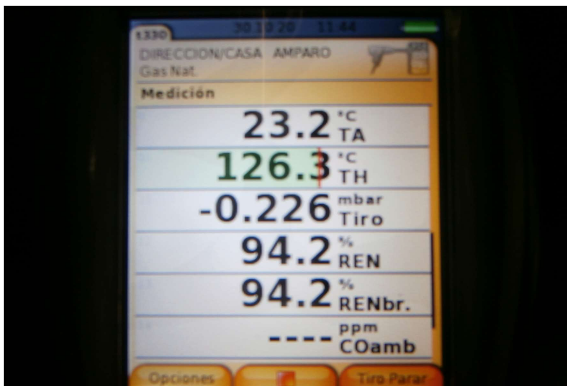
Ilustración 2 Caldera 2 Rendimiento combustión a modulación 25%
