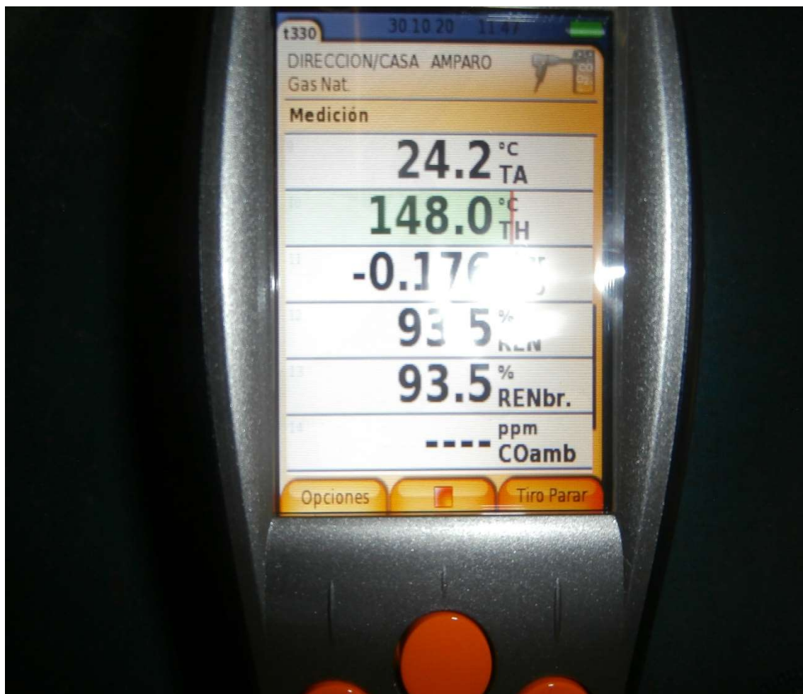
Ilustración 4 Caldera 2 Rendimiento combustión a modulación 40%
