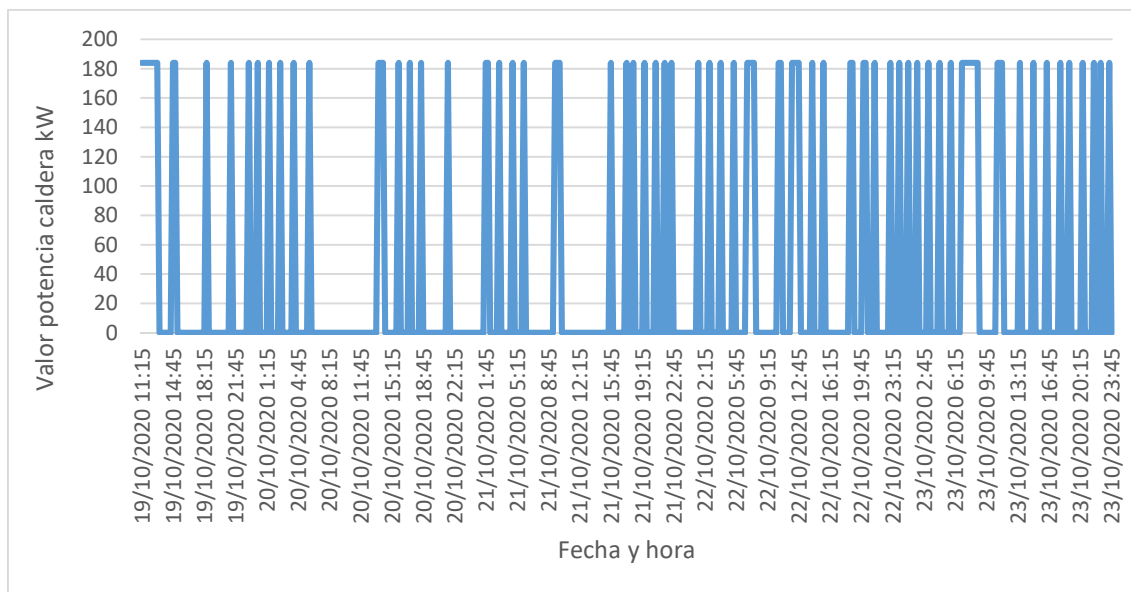
Ilustración 17 Potencia caldera 4 en exclusiva producción ACS
