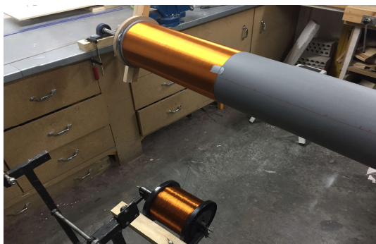
Ilustración 20. Construcción bobina secundaria
