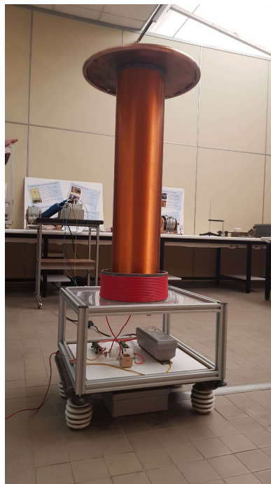
Ilustración 27. Construcción de la bobina de Tesla completa
