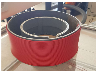
Ilustración 21. Construcción bobina primaria
