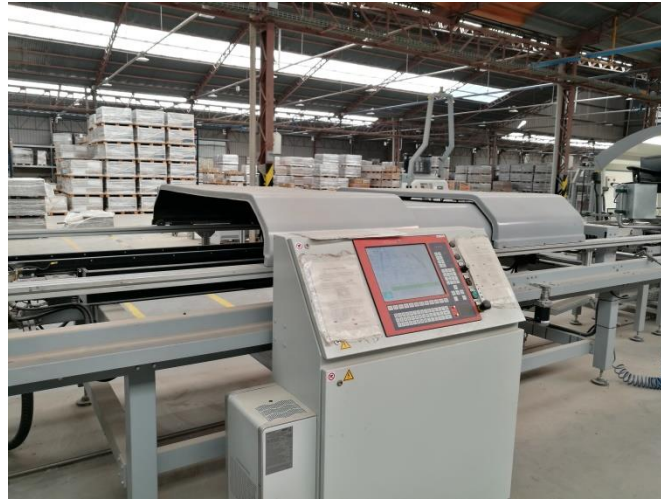
Imagen 15: Control de las piezas con ADVANCHECK (SEL9).
