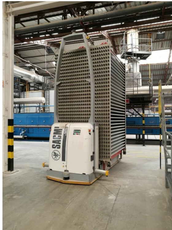
Imagen 3: Transporte box hacia secadero túnel con LGV (HRN9).
