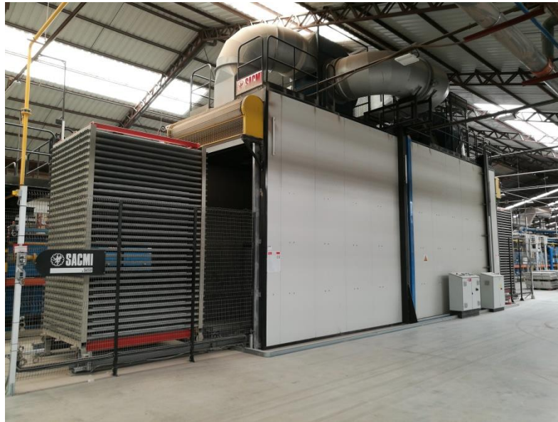
Imagen 4: Introducción de los box en el secadero túnel (HRN9).
