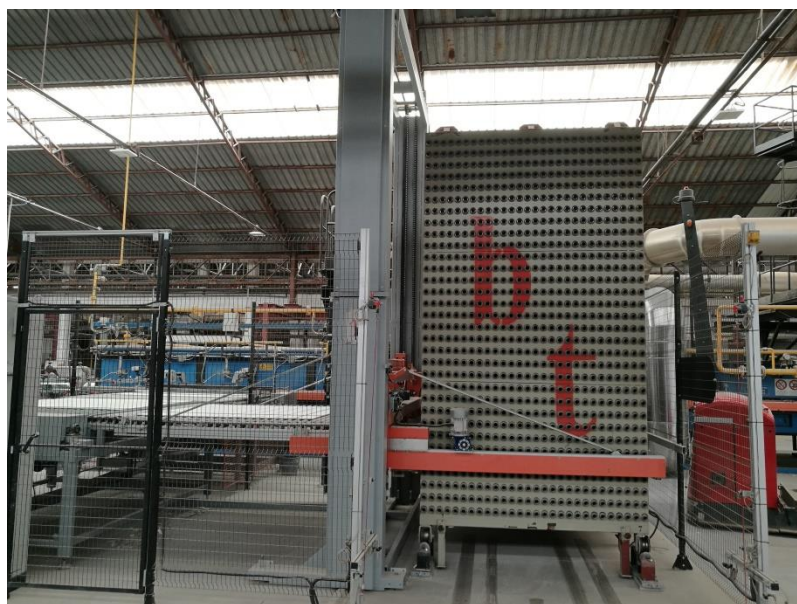
Imagen 5: Extracción de las piezas del box (HRN9).
