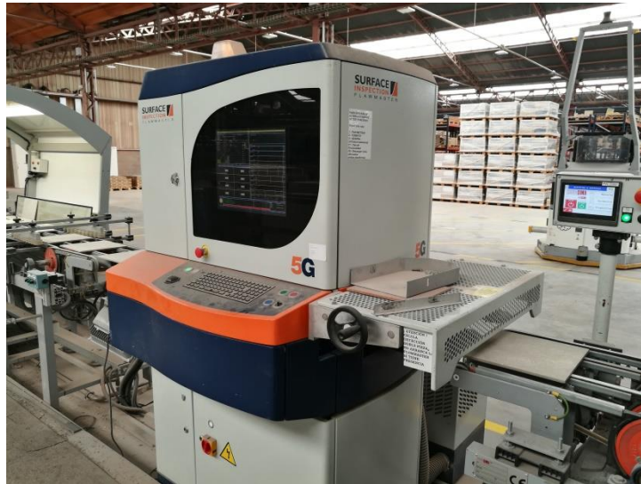
Imagen 13: Control de las piezas con FLAWMASTER 5G (SEL9).
