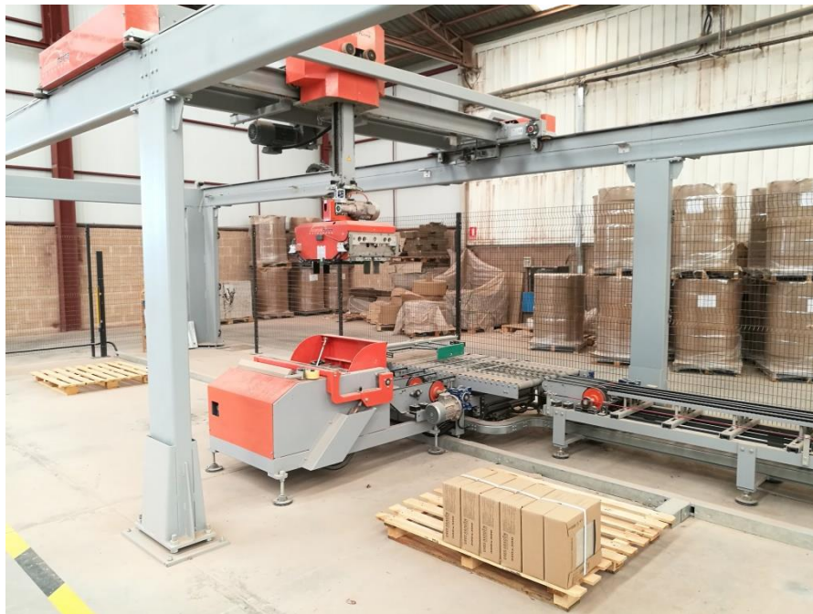
Imagen 20: Robot paletizador (SEL9).
