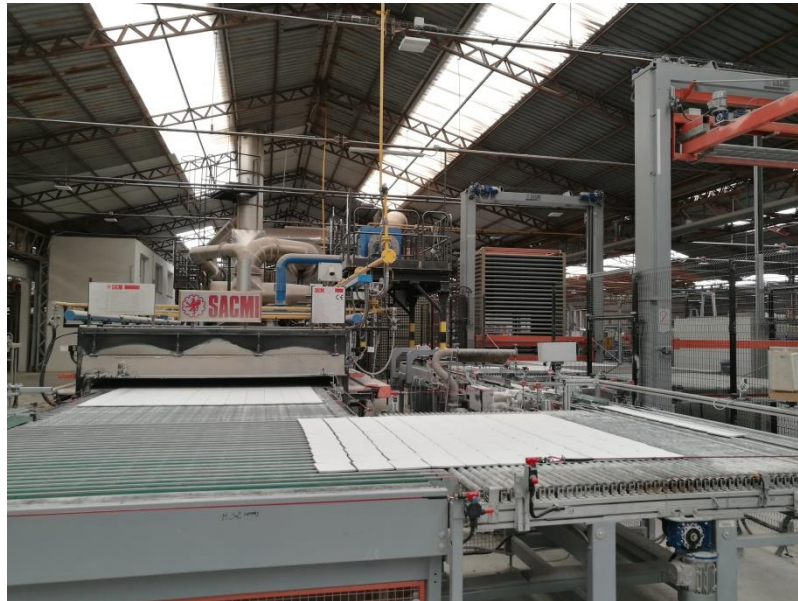
Imagen 6: Entrada de piezas a zona de calentamiento prehorno (HRN9).
