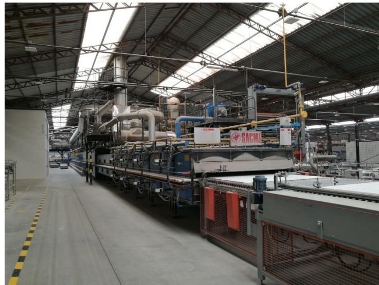
Imagen 7: Zona de prehorno, continuada por el horno (HRN9).
