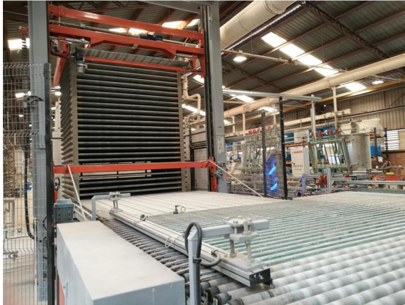
Imagen 2: Introducción de las piezas en los box de transporte (HRN9).
