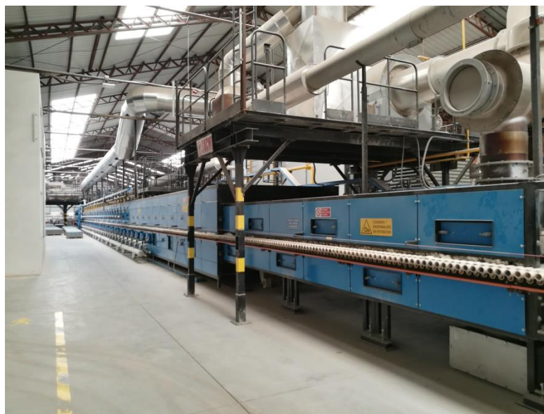
Imagen 8: Zonas prehorno, calentamiento y cocción (HRN9).
