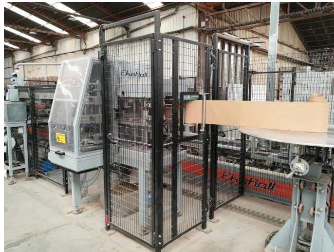
Imagen 17: Entrada y corte del cartón para conformar las cajas (SEL9).
