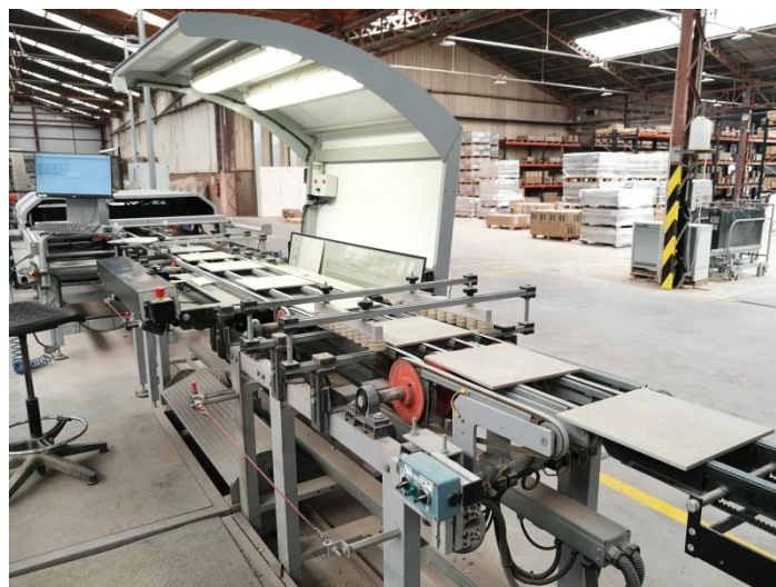
Imagen 14: Control de las piezas en banco de inspección (SEL9).
