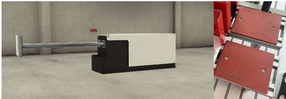
Figura 6: Empujador Factory IO empleado como expulsor vs placas expulsoras estación real
