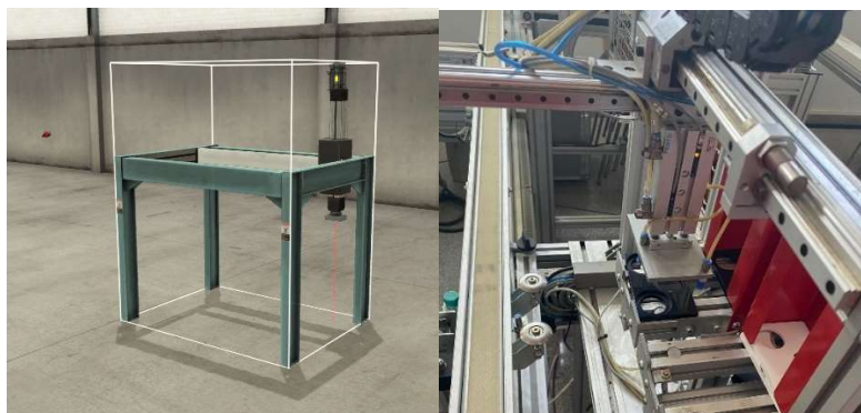
Figura 7: Pick&Place Factory IO empleado como brazo robot vs brazo robot estación real
