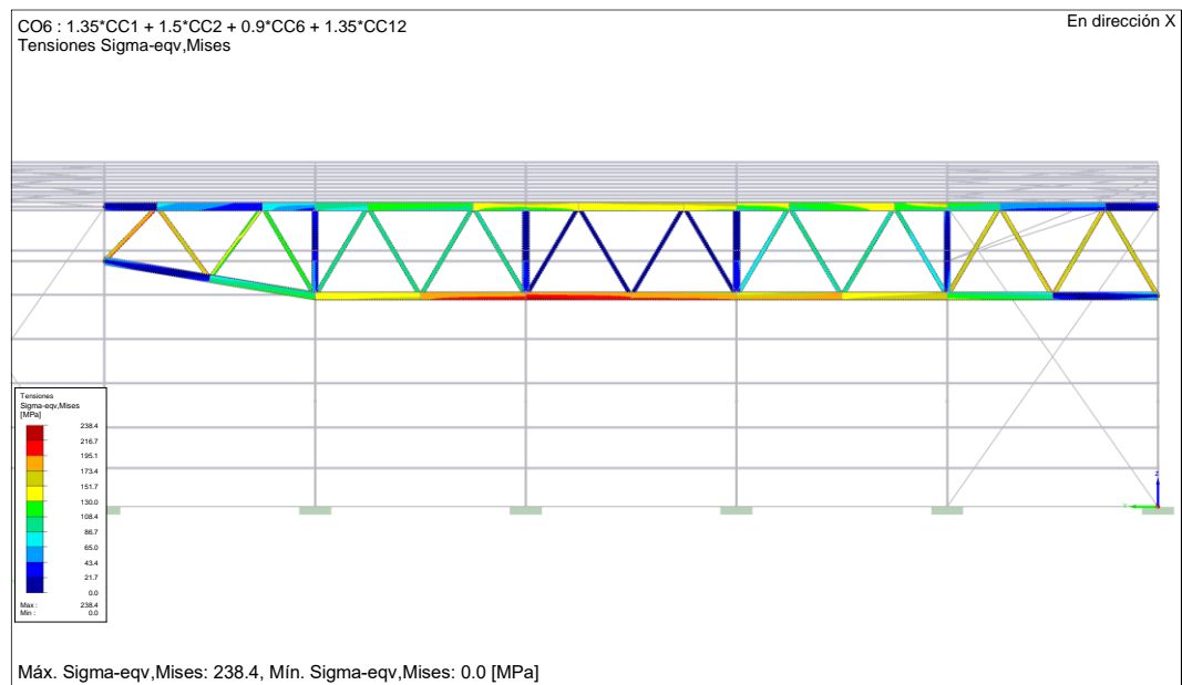
Imagen 3.13. Detalle tensiones máximas – Celosía puerta
