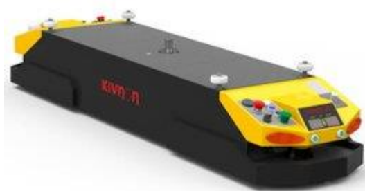
Ilustración 11. AGV de carga unitaria con unión Pin-hook.
